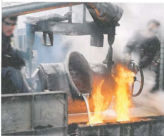
Die Giesser an der Arbeit: Flüssiges Aluminium wird in die Form gegossen.
