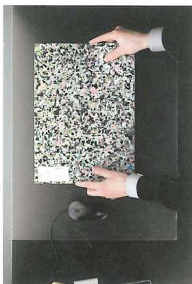
<Die drei Komponenten der RFID-Technik: der Chip (im Materialmuster), das Lesegerät und der Computer.
